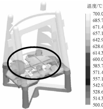
图 12 差压铸造时金属液进入型腔底部区域时温度场
